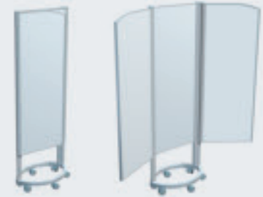
Liikuteltava päätysermi on varustettu kahdella kokoontaitettavalla sivulla, jotka voidaan kääntää eri asentoihin. Sermiä käytetään sängyn päädyssä, tilapäisenä suojana pukeuduttaessa sekä näkösuojana käytävillä. Matala pyöräjaluista on pyöreänmuotoinen, jotta siihen ei kompastuisi. Korkeus: 1,55 m. Leveys avattuna: 1,5 m. Leveys taitettuna: 0,55 m.
